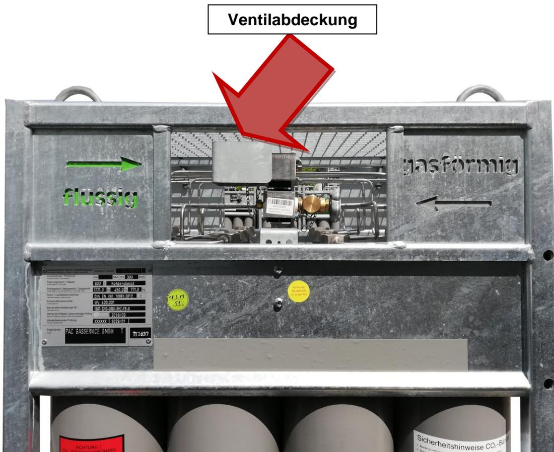
**Abb. 1: Beschriftung Entnahmeventile**
